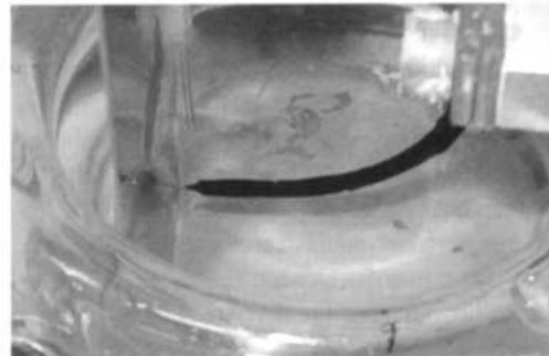
Abb. 3: Selbst gefertigte Edelstahlnadel in Front eines 1.4301-Blech; die Nadel ist – abgesehen von der Spitze – mit einem galvanobeständigem Lack versehen
